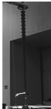
图 8 缠绕护套后鸟粪下落时形成局部电弧
